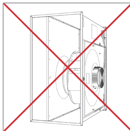
Installerad med motorbryggan åt sidan.
