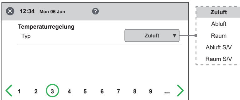
Assistent – 3 Temperaturregelung / Zuluft
