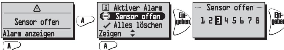
Der aktuelle Alarm wird angezeigt. Wenn „Sensor offen“ und „Sensor kurzgeschlossen“ ist, drücken Sie
