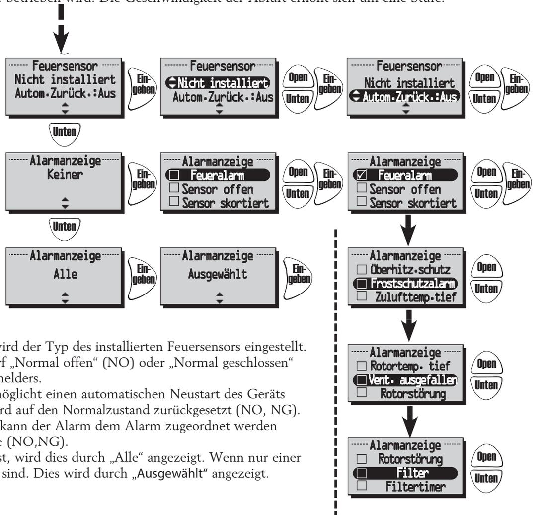
Im Menü „Feuersensor“ wird der Typ des installierten Feuersensors eingestellt. Wählen Sie je nach Bedarf „Normal offen“ (NO) oder „Normal geschlossen“ (NG) die Art des Rauchmelders.
