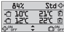
Drücken Sie die Taste **A**, um „Erhöhung aus/ein“ des Zu- und Abluftstroms für einen auszuwählen bestimmte Zeit (Zeit- und Ventilatorzahlseinstellungen während des Boosts). Erfolgt im Servicemenü „Boost“ (Seite 54). Wenn das „Plus“-Symbol in der rechten Ecke angezeigt wird, ist der Boost aktiviert.
