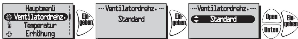
Für HERU®EC, Standardgeschwindigkeit/-modus im Normalbetrieb.
