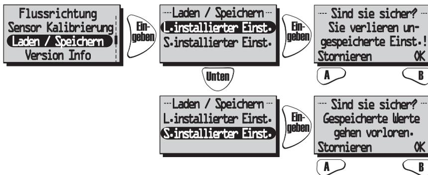
Nachdem Sie „Laden“ oder „Speichern“ ausgeführt haben, kann es eine Minute dauern, bis das Gerät die Verbindung zum WLAN wiederherstellt Steuergerät und die richtigen Daten werden angezeigt.
