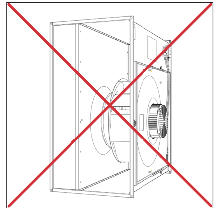
Asennettu moottorisilta sivulle
