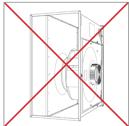
Installert med dekselet til siden
