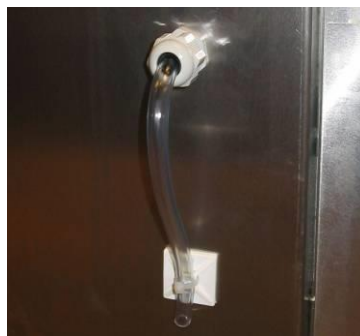
Figur 2. Montering av tryckslang för mätning av atmosfärstrycket.
